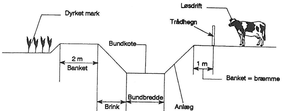
Figur 1 Principtegning banketbredder i landzone.
